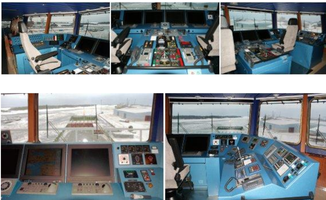
Kuva 6.2. M/s Misida, komentosillan kahdennetut Furunon ECDIS- ja tutakuvaruudut
